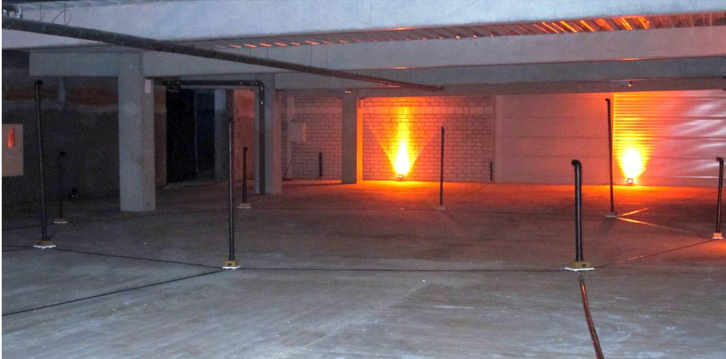
Abbildung 4.1.: Blick auf den zentralen 8-Kanal Lautsprecherkreis, sowie zwei der äußeren Röhren (Nr. 3 und 5; vgl. Abb.4.3)
